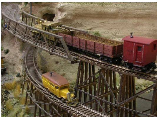
konstruiert. Die einzelnen Verbindungen, vor allem am Ende der Zugstangen, benötigen Sattelhölzer und Schrauben mit grossflächigen Unterlagscheiben.
